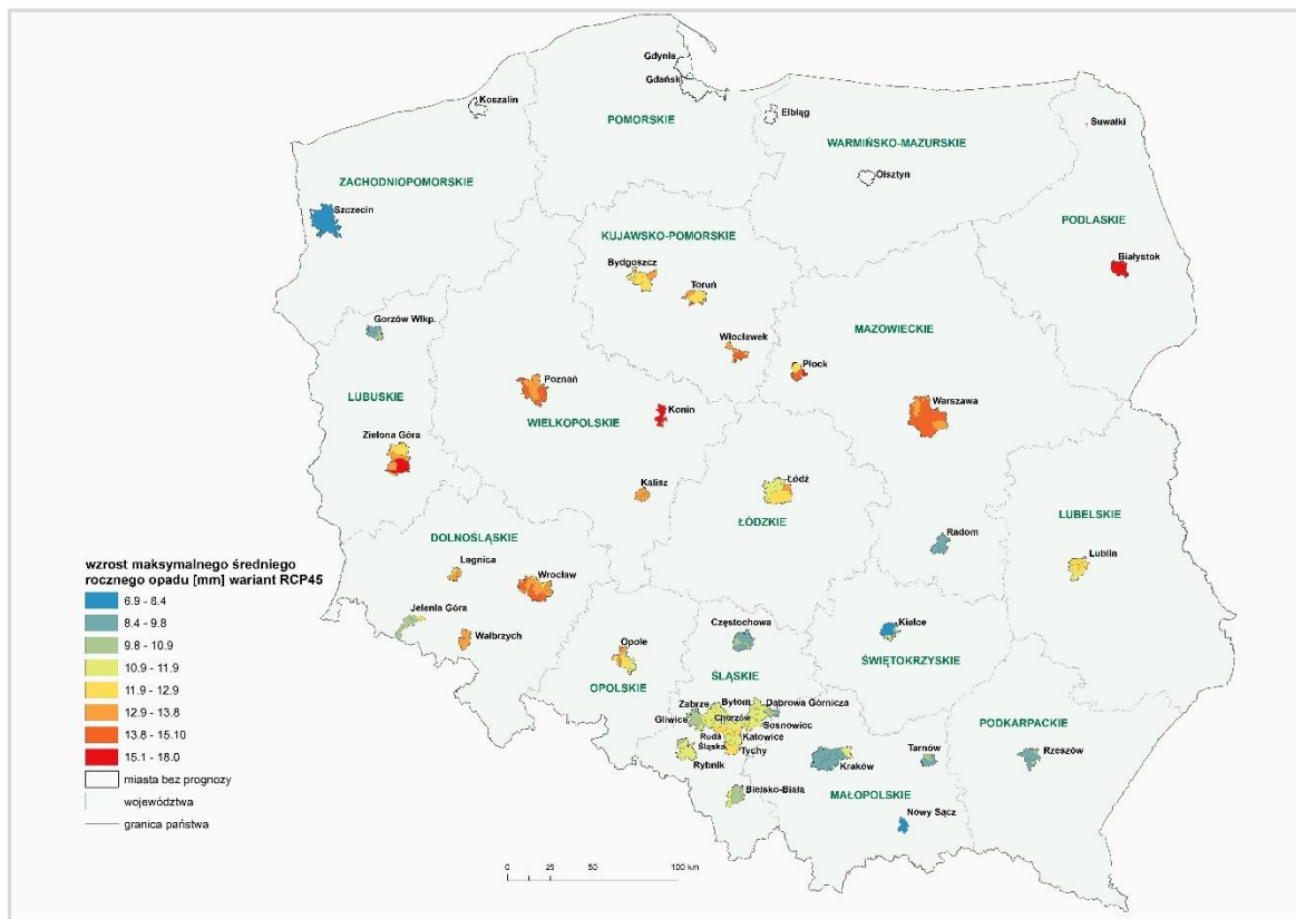
Rysunek 14: Przykład prognozy długofalowej zmiany maksymalnego rocznego opadu w wieloletni 2074-2100 w stosunku do okresu referencyjnego 1974-2000 w największych miastach Polski (opracowano na podstawie wyników projektu CHASE-PL)
